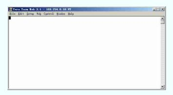
写入大写的 X,然后点击菜单 file—> transfer xmodem send ,选中 srvl.ldr 文件开始烧写。
