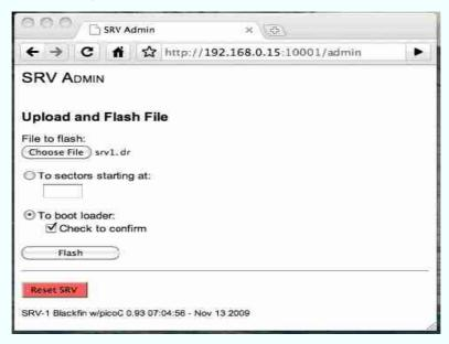
然后点击"Flash"按键上传即可。如果看到类似"xxx bytes uploaded to boot loader"的提示信息,则表示 Firmware 更新成功,如下图所示:
