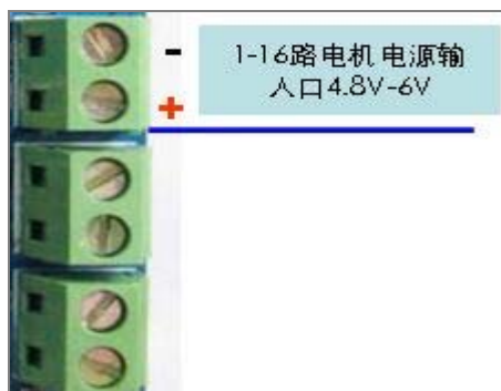
伺服电机电源输入口
