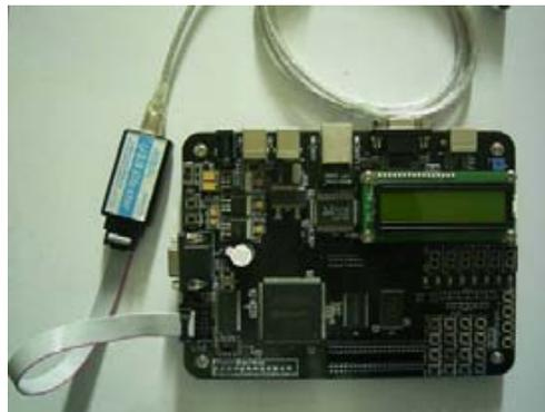
如果希望程序永久保存在硬件系统内则需要使用 AS 方式，需要把下载线连接到开发板的 AS 下载接口，将程序下载到配置芯片内，配置芯片内的程序掉电可以保存，再次上电后自动装载到 FPGA 内并由 FPGA 开始运行。按下配置按键“CONFIG”后，将强制加载配置芯片中的数据到 FPGA 中。
