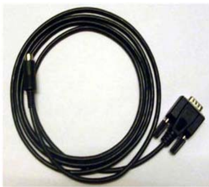
图 8 通信电缆 (PLC)
