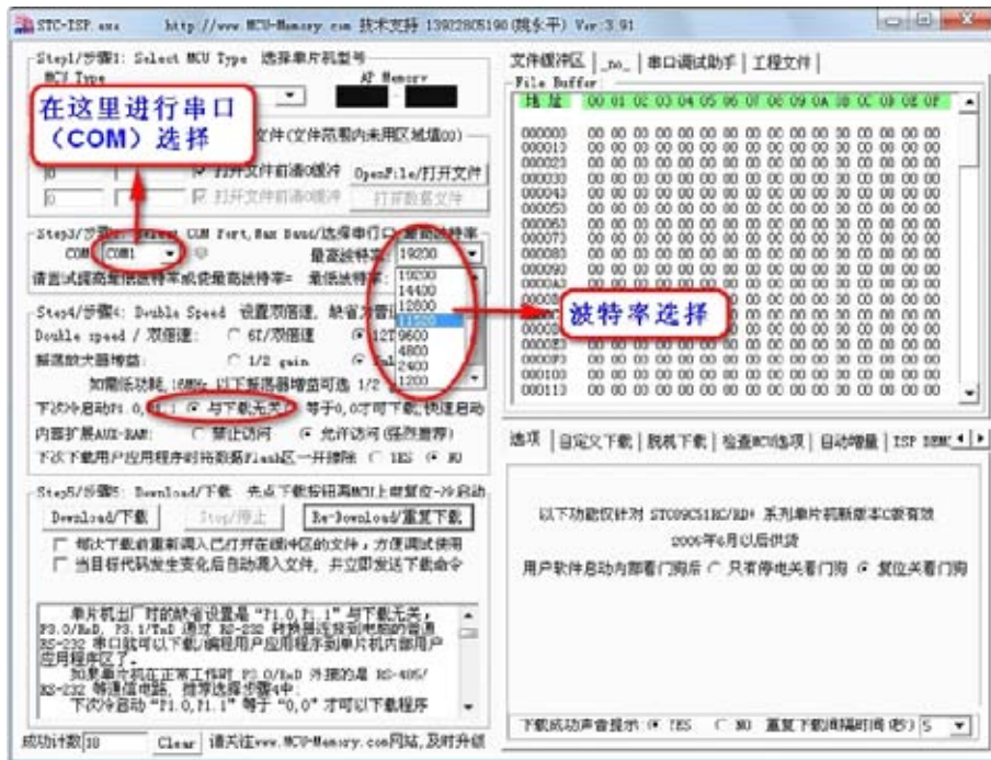
图 1-4 设置下载所使用的 COM 口和波特率
