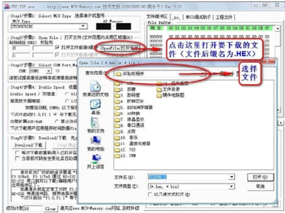
图 1-6 在计算机中找到机械手演示程序的目标代码：EX1_Borad_test.HEX
